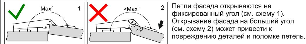
Петли фасада открываются на фиксированный угол (см. схему 1). Открывание фасада на больший угол (см. схему 2) может привести к повреждению деталей и поломке петель.
