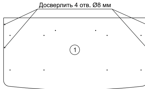
Схема 5. Досверливание отверстий
